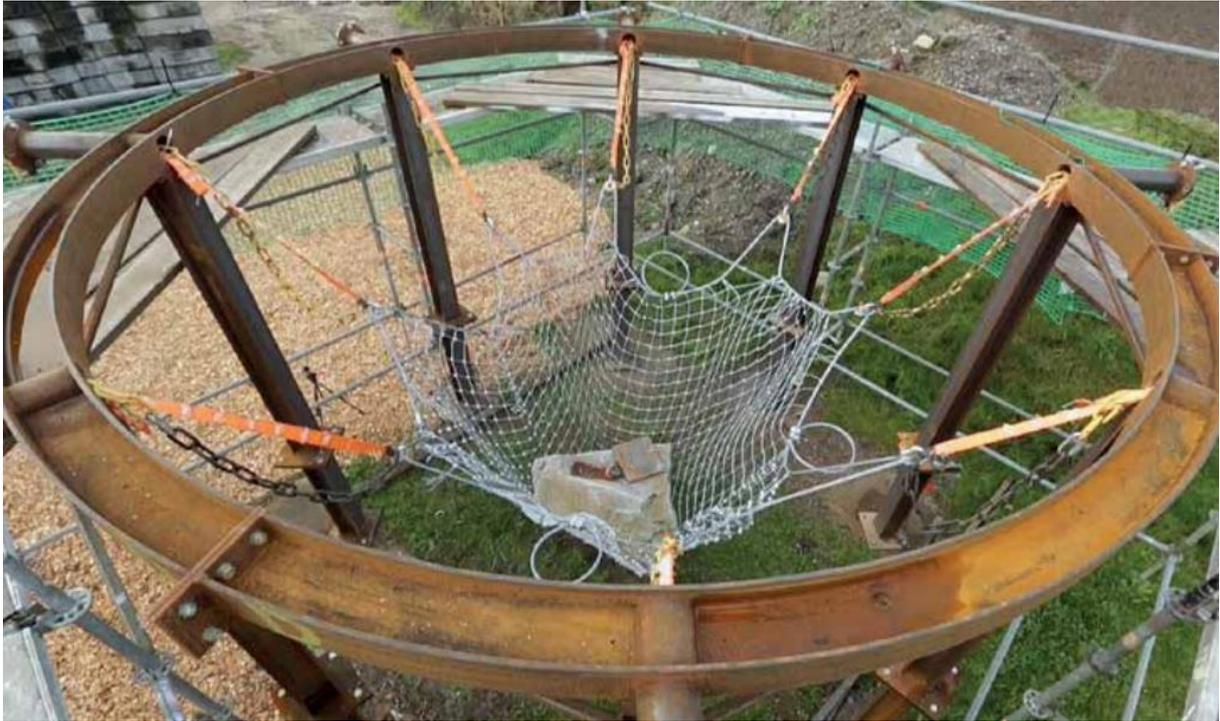
Bei den Fallversuchen wurde die Prüfmass aufgefungen ohne sicherheitsrelevante Beschädigungen des Netzes oder der Federsysteme.
