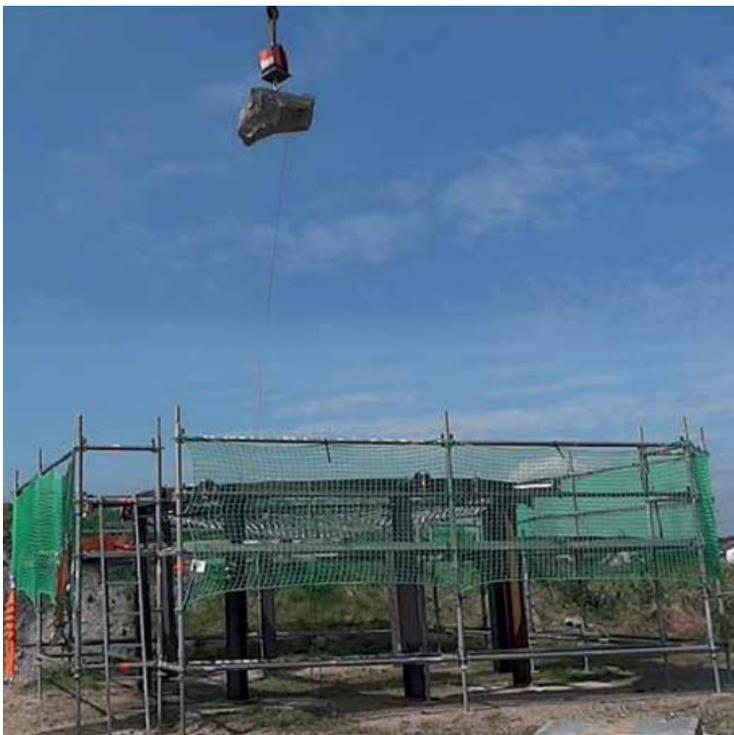
*Prüfkörper war ein Felsbrocken von unregelmäßiger Form mit einer Masse von ca. 700kg. Die Fallhöhe betrug 8m.*
